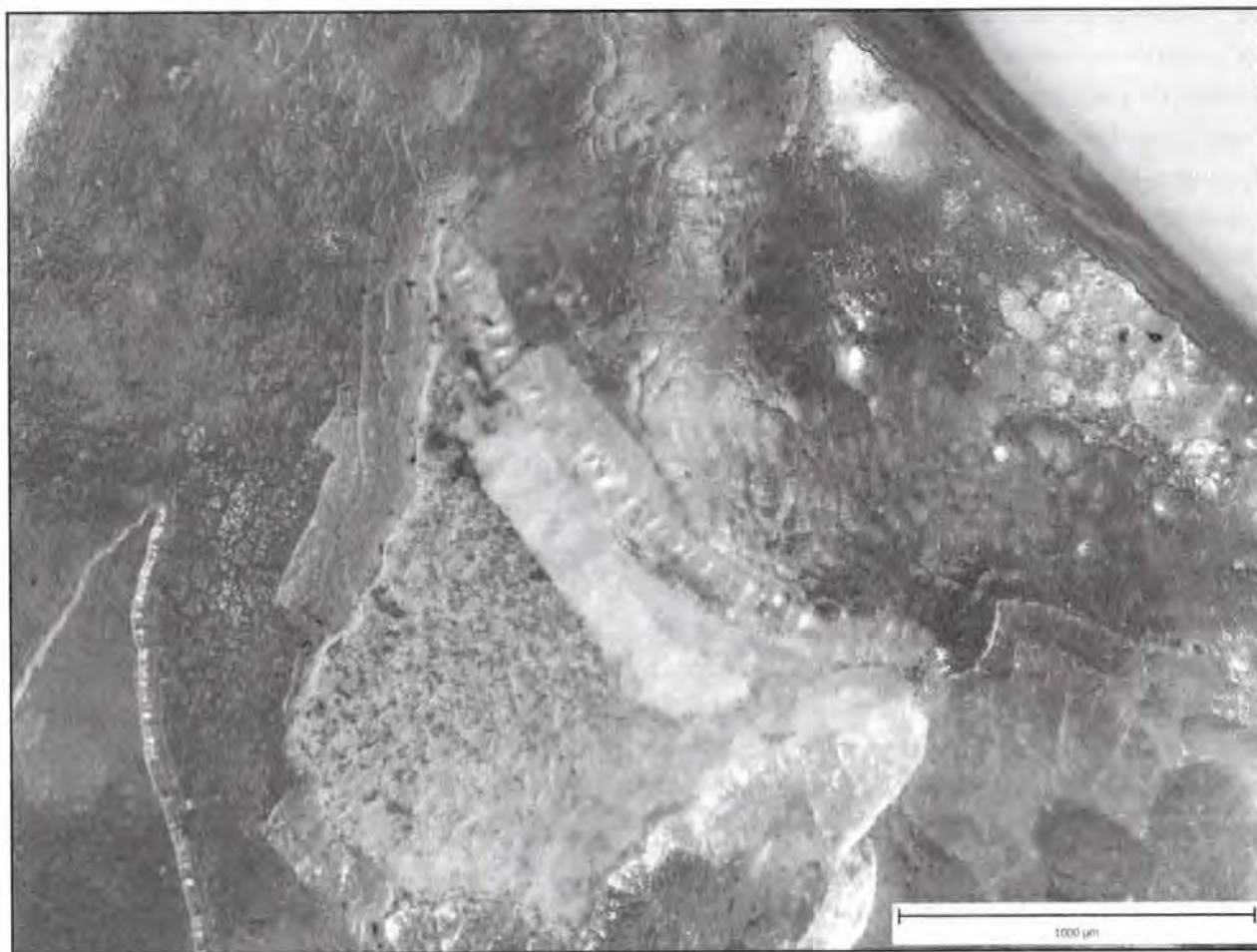
Detail poškození skla korozním procesem
